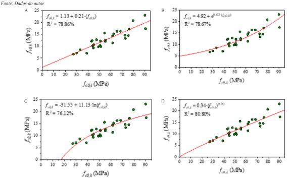
**Figure 1** – Regression models to estimate  $f_{v_{0,k}}$  in terms of  $f_{c_{0,k}}$ : (a) linear; (b) exponential; logarithmic (c); and (d) geometric. **Figura 1** – Modelos de regressão para se estimar  $f_{v_{0,k}}$  em termos da  $f_{c_{0,k}}$ : (a) linear; (b) exponencial; logarítmico (c); e (d) geométrico.
