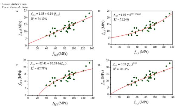
**Figure 2** – Models of regression to estimate  $f_{y_{0,k}}$  from  $f_{M,k}$ : (a) linear; (b) exponential; logarithmic (c); and (d) geometric. **Figure 2** – Modelos de regressão para se estimar  $f_{y_{0,k}}$  a partir da  $f_{M,k}$ : (a) linear; (b) exponencial; logarítmico (c); e (d) geométrico.
